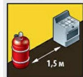
Удаление от плиты, печи или радиатора отопления не менее чем на 1,5 м
