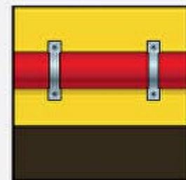
Шланг не должен быть пережат или растянут и должен быть зафиксирован с помощью зажимов безопасности
