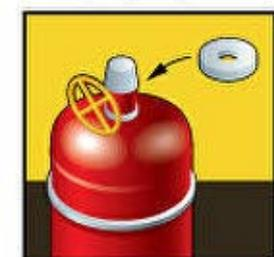
Прокладку между краном баллона и регулятором менять при каждой новой установке
